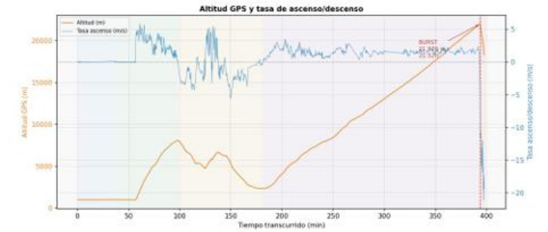
Figura 1. Altitud GPS real (naranja, eje izquierdo) y tasa de ascenso/descenso en m/s (azul, eje derecho). La línea roja discontinua momento del burst.
